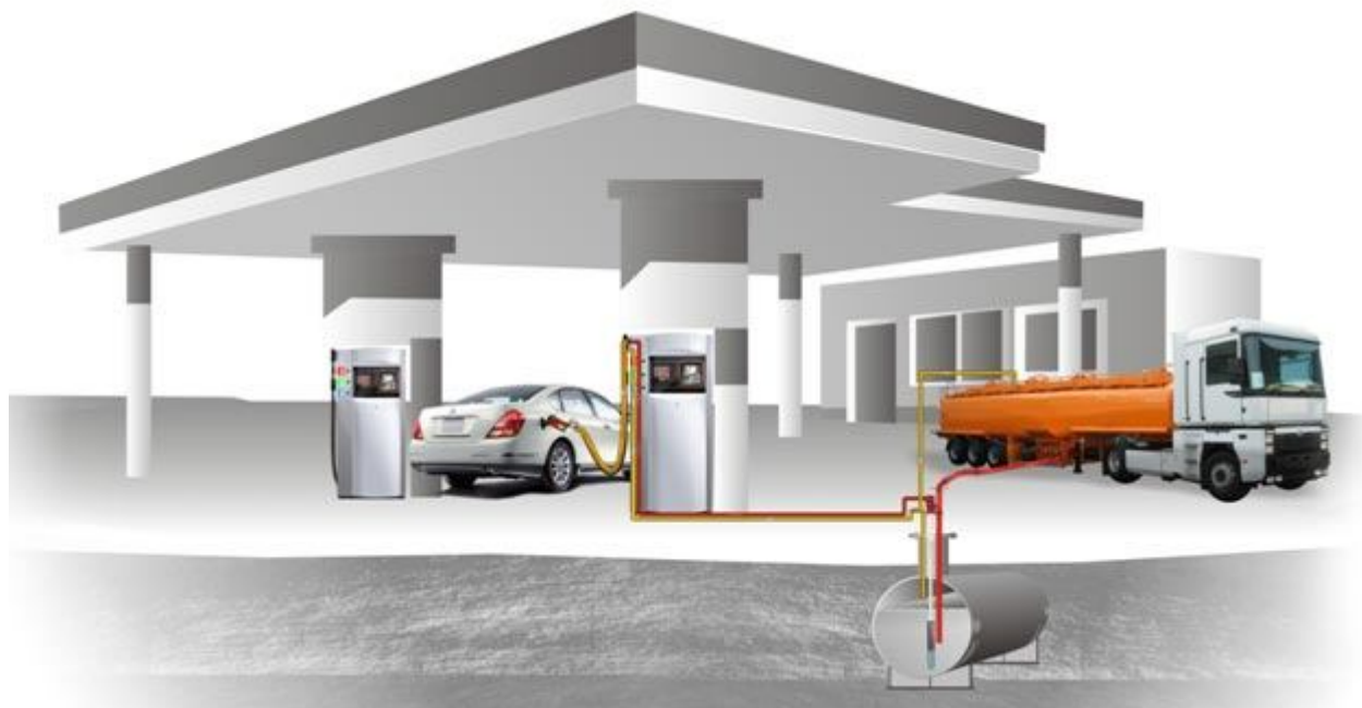
Рисунок 2 - Схема чистой заправки автомобиля и слива продукта из автоцистерны с возвратом паров
